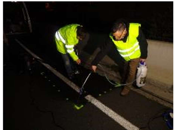
ნახაზი 3. 15 - გამოყენებული მტვერსასრუტი, ლაბორატორიაში და ქუჩის სექციებში გამოყენებისას.
